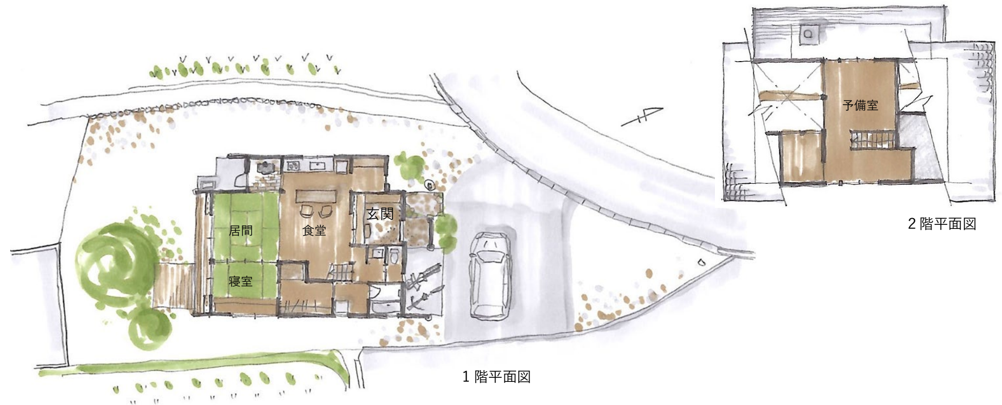
浴室を除いて、仕上げは杉・桧と左官屋オリジナル配合の砂漆喰壁。床・天井（化粧野地・荒野地）共に 30 mm 杉板を使用し、下地合板はゼロ。
