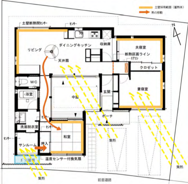
直射光を入れず道路からの視線に配慮した窓を設け落ち着きのある空間とした和室日射による集熱が無いため熱容量の大きい土壁を全面に採用し他の室で集熱した熱を送り込むことで暖房器具無しで快適に過ごせるようにした
