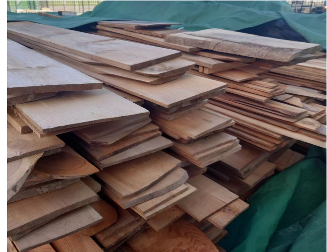
解体する家屋から生捕りした廃材（松の板材）
