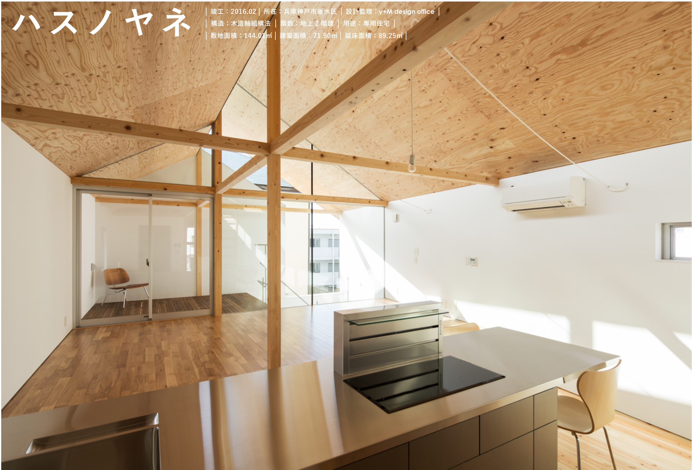
柱・梁には県産桧材を使用し、空間にアクセントを与えている
