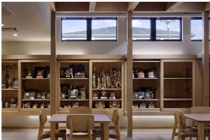
構造木柱から梁を架け渡した軸組をベースに展示棚を構成することで、学校の様々な歴史的な事物を収蔵するための、力強く素朴な質感のデザインを目指しています。
